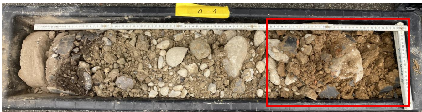
Abbildung 2: Bohrkern RB4 0 - 1 m, rot umrandet beprobte Schicht 0.7 - 1.0 m
